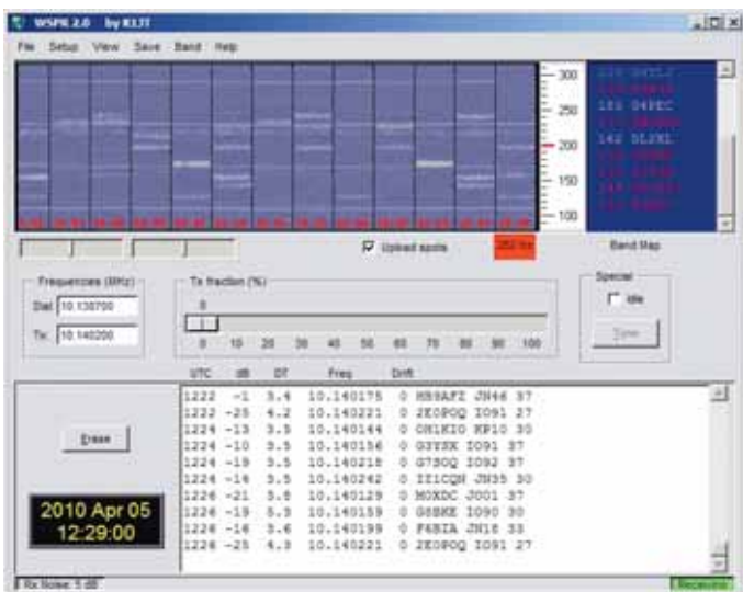
Der Hauptbildschirm von WSPR zeigt grafisch die empfangenen Signale im 2-Minuten-Raster, dazu die eingestellte Frequenz und die dekodierten Angaben der Sendestationen.
